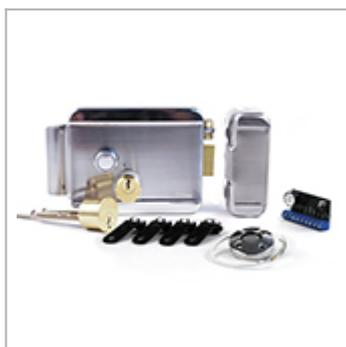
**Электромеханический замок «Anxing Lock-Зенит»** изготовлен в металлическом антивандальном корпусе и может использоваться как в уличных условиях, так и в помещениях. Открытие замка происходит касанием считывателя электронным ключом, обычным механическим ключом, или кнопкой выхода на корпусе замка.
